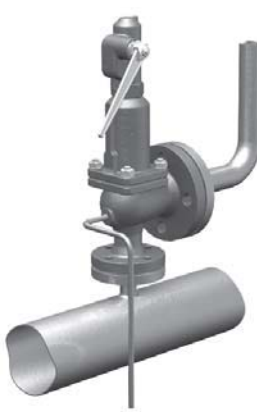
Правильная установка на паропровод
